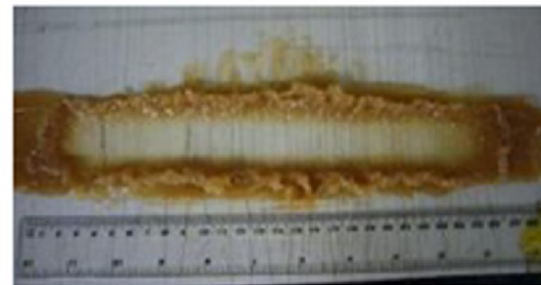
写真4 メカスイングノズルのエアブロー前後
