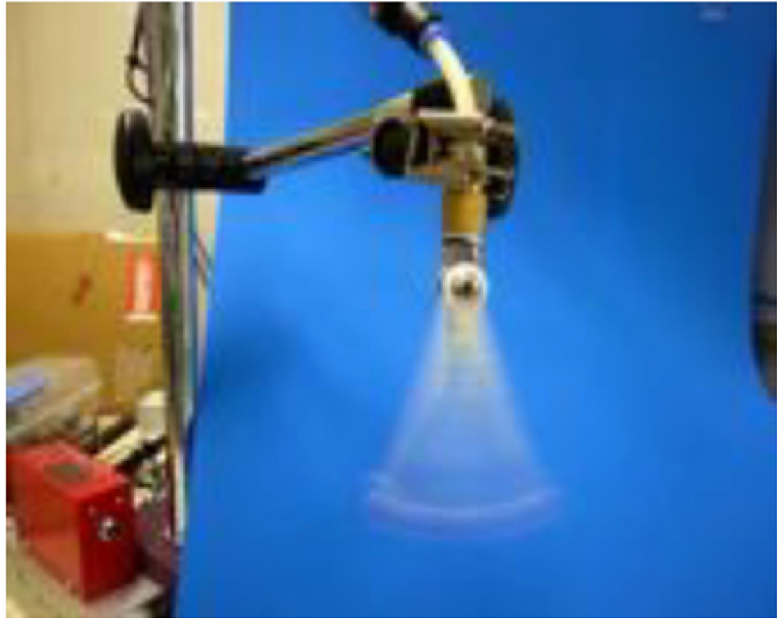
動画1 メカスイングノズルの動き (エア圧力0.4MPa時) 揺擺式噴槍的動作 (氣壓=0.4Mpa時)
