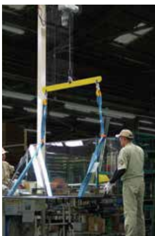
大型玻璃窗的 翻轉作業
