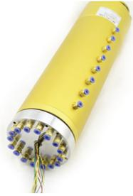
MAPH1000 气/液+电 旋转接头，可通M5、G1/8、G1/4、G3/8、G1/2大小管径，且可以混合功率动力线、信号线、以太网、USB、工业总线、控制线、电磁阀、感应线等；标准为法兰安装形式，可定制空心轴安装。
