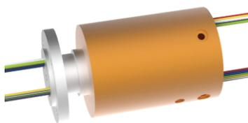
MAPH104 气/液+电 旋转接头, 可通M5、G1/8、G1/4、G3/8、G1/2大小管径, 且可以混合功率动力线、信号线、以太网、USB、工业总线、控制线、电磁阀、感应线等; 标准为法兰安装形式, 可定制空心轴安装。
