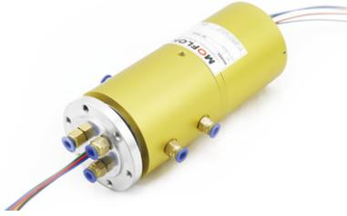
MAPH300 气/液+电 旋转接头, 可通M5、G1/8、G1/4、G3/8、G1/2大小管径, 且可以混合功率动力线、信号线、以太网、USB、工业总线、控制线、电磁阀、感应线等; 标准为法兰安装形式, 可定制空心轴安装。
