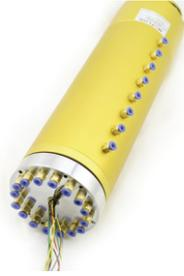
MAPH1200 气/液+电 旋转接头, 可通M5、G1/8、G1/4、G3/8、G1/2大小管径, 且可以混合功率动力线、信号线、以太网、USB、工业总线、控制线、电磁阀、感应线等; 标准为法兰安装形式, 可定制空心轴安装。
