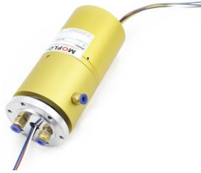
MAPH200 气/液+电 旋转接头, 可通M5、G1/8、G1/4、G3/8、G1/2大小管径, 且可以混合功率动力线、信号线、以太网、USB、工业总线、控制线、电磁阀、感应线等; 标准为法兰安装形式, 可定制空心轴安装。
