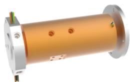
MAPH400W 气/液旋转接头，气滑环，液压滑环，自带转子双法兰，可轴向承重100公斤，可配M5、G1/8、G1/4、G3/8、G1/2大小接头，可定制更大的接头比如G1"，G2"，能通过的介质有：压缩空气、氢气、氮气、化学混合气体、蒸汽、冷却水、热水、热油、石油、硫酸、饮料等。
