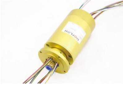
MAPH101 气/液+电 旋转接头, 可通G1/8; G3/8; 接头, 4~12mm大小管径, 且可以混合功率动力线、信号线、以太网、USB、工业总线、控制线、电磁阀、感应线等; 标准为法兰安装形式, 可定制空心轴安装。
