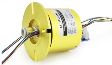
MAPH100 气/液+电 旋转接头，可通M5；G1/8；G1/4；G3/8；G1/2接头，4~12mm大小管径，且可以混合功率动力线、信号线、以太网、USB、工业总线、控制线、电磁阀、感应线等；标准为法兰安装形式，可定制空心轴安装。
