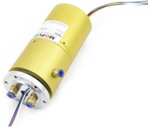
MAPH200S 气/液+电 旋转接头, 可通M5、G1/8、G1/4、G3/8、G1/2大小管径, 且可以混合功率动力线、信号线、以太网、USB、工业总线、控制线、电磁阀、感应线等; 标准为法兰安装形式, 可定制空心轴安装。
