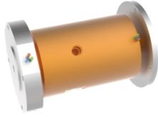
MAPH200W 气/液旋转接头, 气滑环, 液压滑环, 自带转子双法兰, 可轴向承重100公斤, 可配M5、G1/8、G1/4、G3/8、G1/2大小接头, 可定制更大的接头比如G1", G2", 能通过的介质有: 压缩空气、氢气、氮气、化学混合气体、蒸汽、冷却水、热水、热油、石油、硫酸、饮料等。
