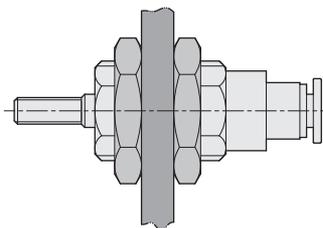
● NA2B 系列須另外購買接頭配件使用。NA2T 系列可直接插入PU管使用。
